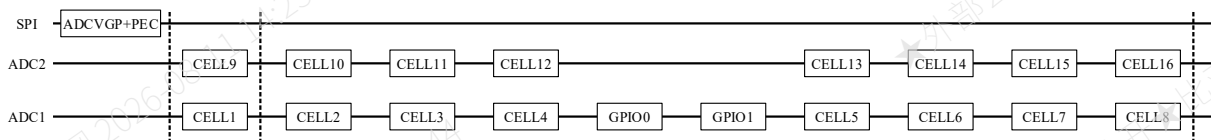
图 4.8 ADCVGP 指令测量 16 节电池和 2 个 GPIO 时序图
