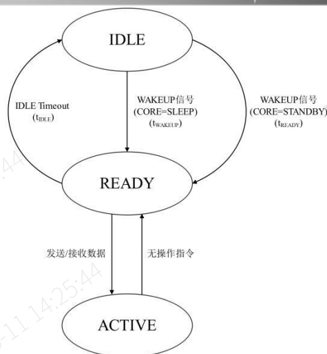
图 3.5 菊花链 SPI 通信电路工作模式切换图
